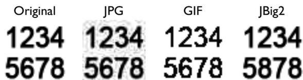
Abbildung 3. Testbilder dreier Kompressionsverfahren auf einem kleinen Pixelbild mit Ziffern; Artefakte sind manuell erzeugt. Im JPG-Bild sind typische Blockartefakte zu sehen. Im GIF-Bild sieht man Auswirkungen einer Farbreduktion. Wer findet das Artefakt im rechten JBig2-Bild?
